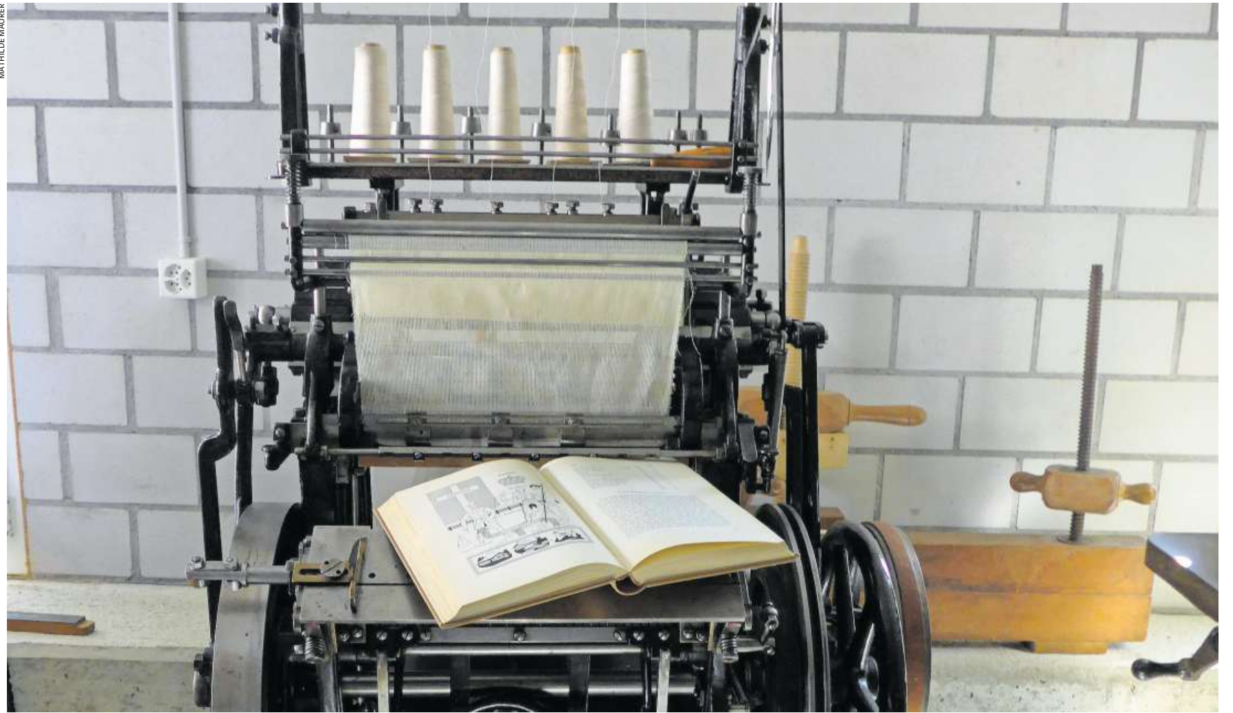
Früher wurden Schulbücher noch auf solchen Maschinen hergestellt: Heimatbuch auf einer Bücherheftmaschine aus den 1950er Jahren.
